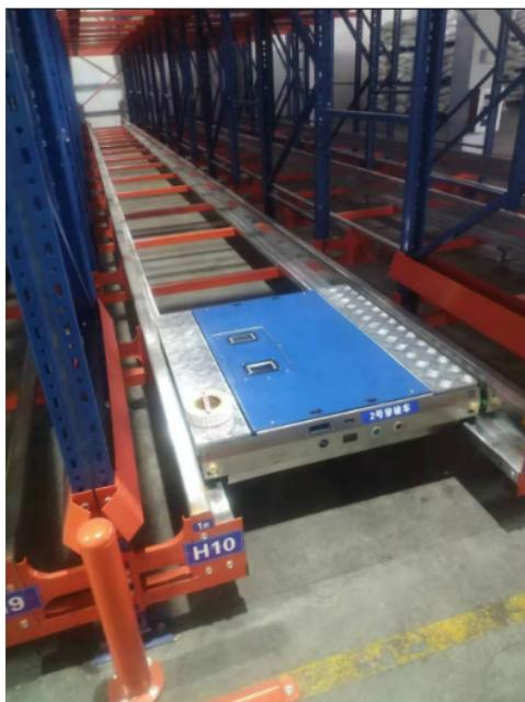
穿梭车调动管理系统。穿梭车调度管理系统由计算机、通信卡、调度管理软件和通信软件组成。穿梭车有自己的控制PLC负责控制单个穿梭车的行走、转弯、定位和运输。穿梭车和穿梭车调度系统采用Profibus-DP总线配置，实现及时、自由的通信。穿梭车是穿梭货架中使用的重要部件之一。近年来，由于梭式货架具有经济、环保、自动化、成本优势和灵活性好的特点，受到越来越多需求者的青睐。使穿梭式仓储货架的使用范围更广，对企业仓储、物流和整体效益的高效提升起到了很好的促进作用。这正是那句话的答案：科学技术是首要生产力。连云港货架穿梭车厂家直销多层穿梭车的运营模式开始进入市场，其具有运营速度快、货物装载更加高效、多延伸存储等优势。
